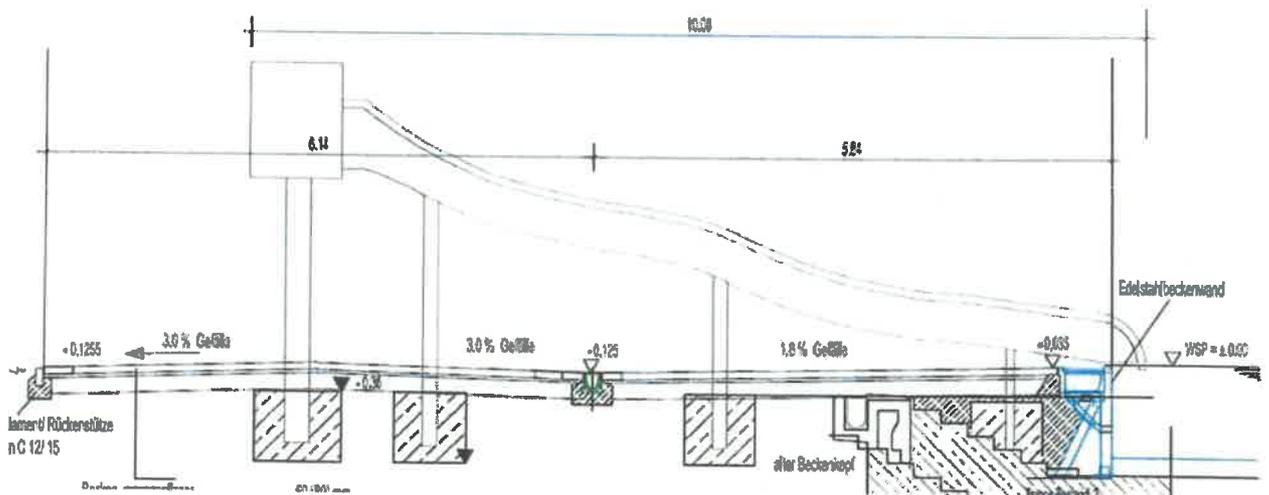
Eine Rutsche wie oben dargestellt benötigt ab Vorderkante Beckenwand ca. 10,10 m Platzbedarf nach hinten zuzüglich mind. 2,50 m Beckenumgang.
