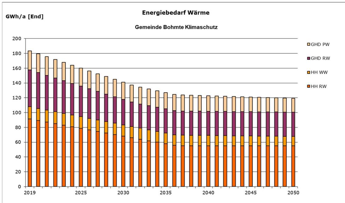
5-17: Wärmebedarf nach Nutzung: Die Haushalte mit Raumwärme und Warmwasserwärme, das Gewerbe, Handel und Dienstleistungen (GHD) mit Raumwärme und Prozesswärme, bis 2050 (Quelle: EKP)
