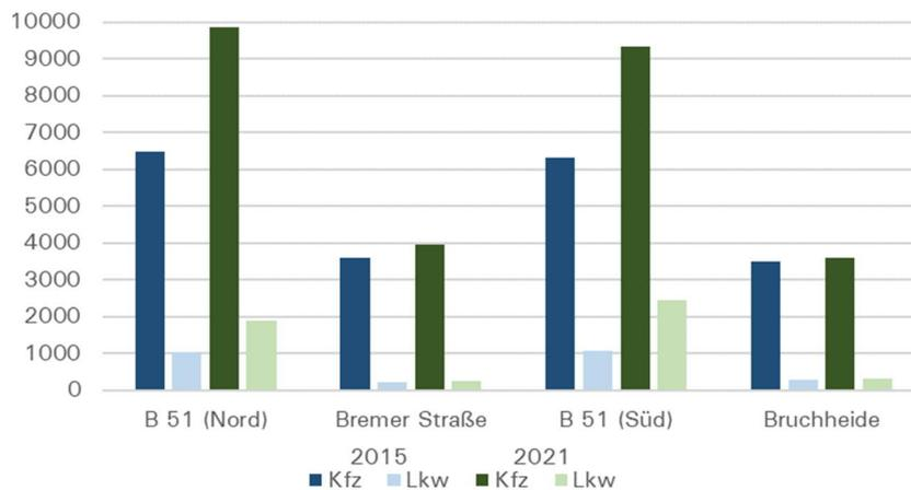
Abb. 40 Vergleich der Belastungen in 2015 und 2021 am KP 09
