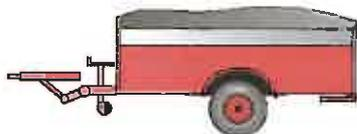
Feuerwehranhänger sind für den Feuerwehreinsatz gestaltete Anhänger mit spezieller Beladung z.B. Rettungsboot oder Löschpulver.
