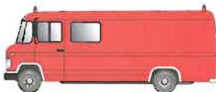
Dieses Fahrzeug dient dem MBohmte, Spüren und Melden radioaktiver und chemischer Kontamination, der Suche nach radioaktiven Trümmern und der Kennzeichnung und messtechnischen Überwachung kontaminierter Bereiche auch abseits befestigter Wege. Die Besatzung besteht aus 4 Personen. Mit der verlasteten Ausstattung können radiologische und chemische Messwerte sowie Ortskoordinaten automatisch erfasst und – soweit erforderlich – nach rechnergestützter Aufbereitung an die Leitstelle übermittelt werden.
