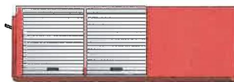
Abrollbehälter mit verschiedenen Löschmitteln. Dies sind Schaummittel, Löschgase wie CO<sub>2</sub>, Löschpulver sowie Sand für die Brandbekämpfung bei Metallbränden.
