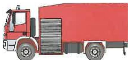
Schlauchwagen dienen dem Nachschub von Druckschläuchen und Armaturen sowie zum Verlegen von Druckschläuchen über lange Strecken. Der Einsatz erfolgt bei unzureichender Löschwasserversorgung oder bei Ausfall der Sammelwasserversorgung. Genormt war der SW 2000-Tr mit 2000 m Schläuchen. Die Besatzung besteht aus einem Trupp. Dieses Fahrzeug ist inzwischen nicht mehr genormt und wurde durch einen GW-Logistik mit Zusatzmodul Wasserversorgung ersetzt.
