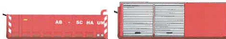
Austauschbarer Aufbau für Wechseladerfahrzeuge. Ein AB kann ein kastenförmiger Container, ein Pritschenaufbau, eine Kippmulde o.ä. sein. Abrollbehälter können in kürzester Zeit vom Fahrzeug auf- bzw. abgesattelt werden. Abrollbehälter finden dann Verwendung, wenn wegen geringer Einsatzfrequenz die Beschaffung eines jeweils hierfür spezialisierten Fahrzeugs nicht angezeigt ist, die Mittel aber dennoch vorgehalten werden müssen.
